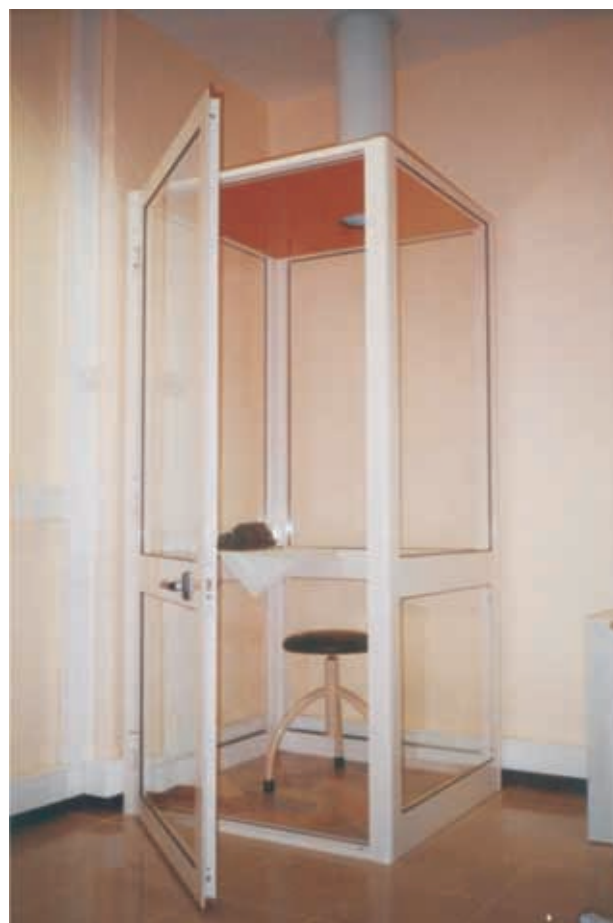
Figura 1. Cabina de provocação inalatória com pressão negativa com amostra de fibras têxteis para manuseamento Figure 1. Negative pressure inhalation challenge chamber with sample of textile fibres for handling
