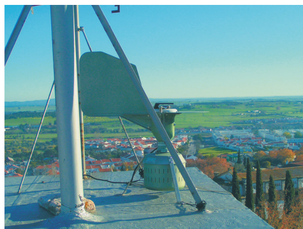
Figura 1. Burkard Seven Day Volumetric Spore-trap®. Método volumétrico de Hirst.
